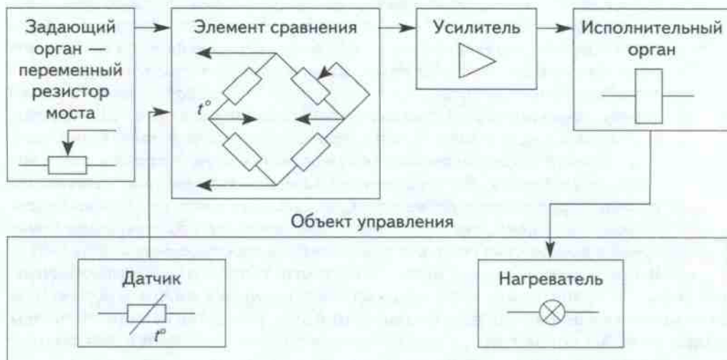
Рис. 35. Структурная схема автомата для поддержания температуры воды на заданном уровне
