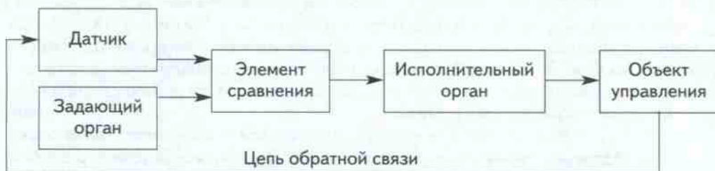
Рис. 34. Структурная схема автоматического регулирования
