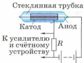
Рис. 159. Схема устройства счётчика Гейгера
