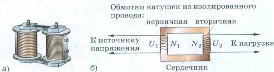
Рис. 134. Внешний вид и схема устройства повышающего трансформатора
