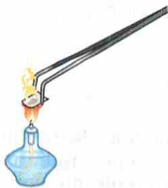
Рис. 153. При внесении в пламя газовой горелки кусочка поваренной соли пламя окрасится в жёлтый цвет
