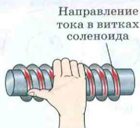
Рис. 97. Определение направления линий магнитного поля внутри соленоида
