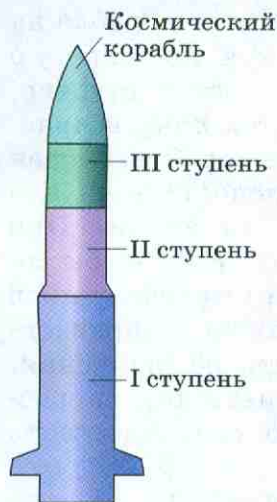
Рис. 49. Схема трёхступенчатой ракеты
