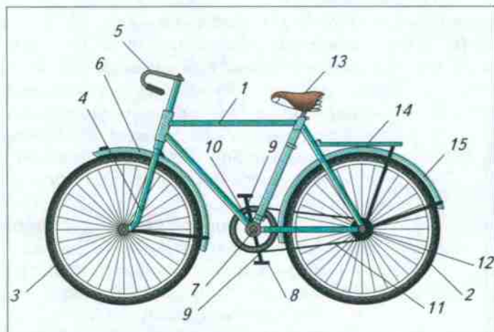
Рис. 107. Устройство велосипеда: 1 — рама, 2 — заднее колесо, 3 — переднее колесо, 4 — вилка, 5 — руль, 6 — щиток передний, 7 — вал, 8 — педаль, 9 — шатун (кривошип), 10 — звёздочка педалей, 11 — цепь, 12 — звёздочка заднего колеса, 13 — седло, 14 — багажник, 15 — щиток задний
