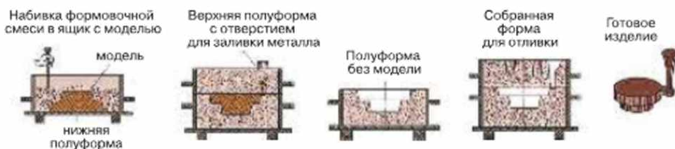
Рис. 5.3. Изготовление формы для отливки изделия
