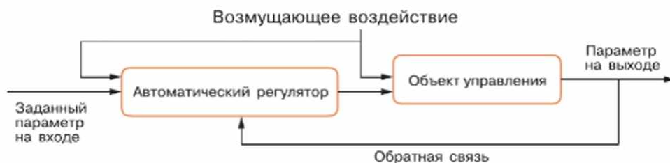
Рис. 4.6. Автоматическая система управления, работающая на принципе комбинированного управления
