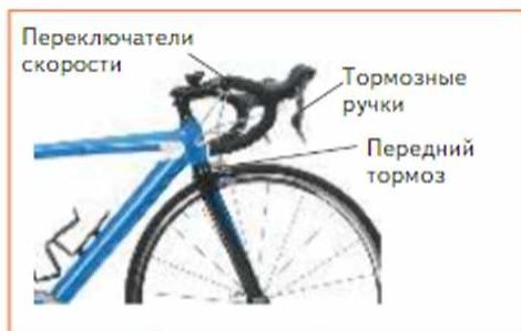
Рис. 4.1. Органы управления самокатом (а) и велосипедом (б)
