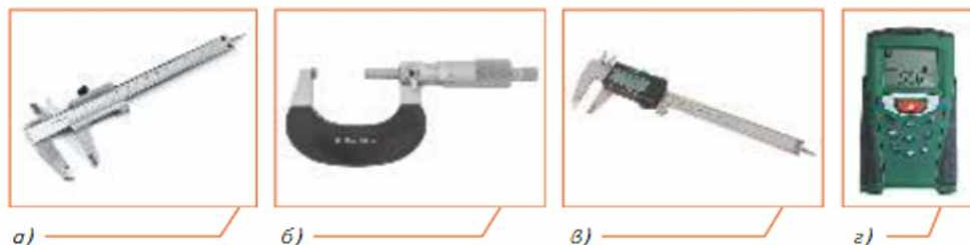
Рис. 2.4. Приборы для измерения линейных размеров: а — механический штангенциркуль; б — механический микрометр; в — электронный штангенциркуль; г — лазерный дальномер
