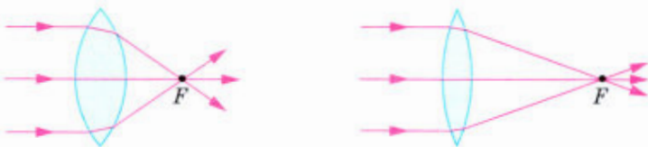
Рис. 156. Преломление лучей линзами различной кривизны
