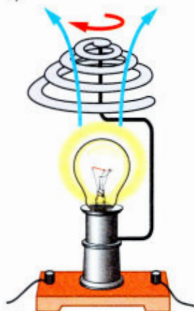
Рис. 12. Конвекция: а — в жидкости; б — в воздухе
