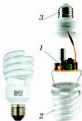
Рис. 128. Энергосберегающая лампа: 1 — пускорегулирующее устройство; 2 — стеклянная колба, покрытая люминофором; 3 — цоколь
