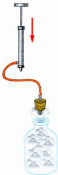
Рис. 6. Уменьшение внутренней энергии воздуха при совершении им работы
