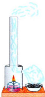
Рис. 14. Модель для демонстрации тяги
