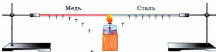
Рис. 11. Теплопроводность разных металлов
