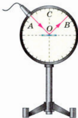
Рис. 138. Прибор для наблюдения изменения угла падения света
