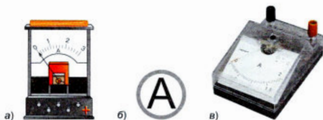
Рис. 82. Амперметр: а — демонстрационный; б — обозначение на схемах; в — лабораторный
