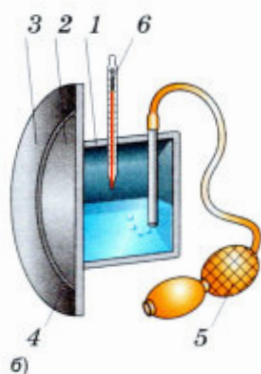
Рис. 33. Конденсационный гигрометр: а — внешний вид; б — устройство
