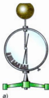
Рис. 53. Электрометр: а — внешний вид; б — механизм зарядки
