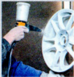
Равномерное окрасивание изделия наэлектризованной краской
