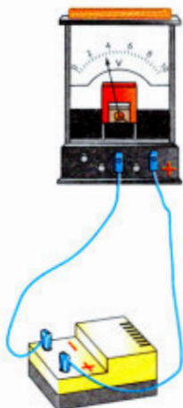
Рис. 87. Подключение вольтметра к источнику тока
