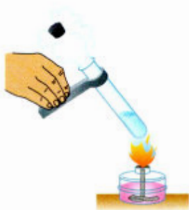
Рис. 41. Работа водяного пара, вызывающая движение пробки
