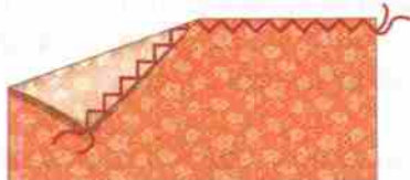
Рис. 77. Обмётывание зигзагообразной строчкой
