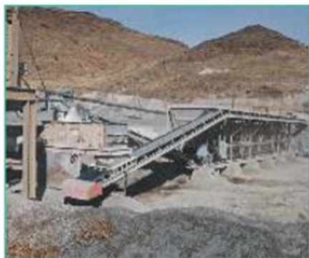
Рис. 4.8. Агрегат для сушки и просеивания песка
