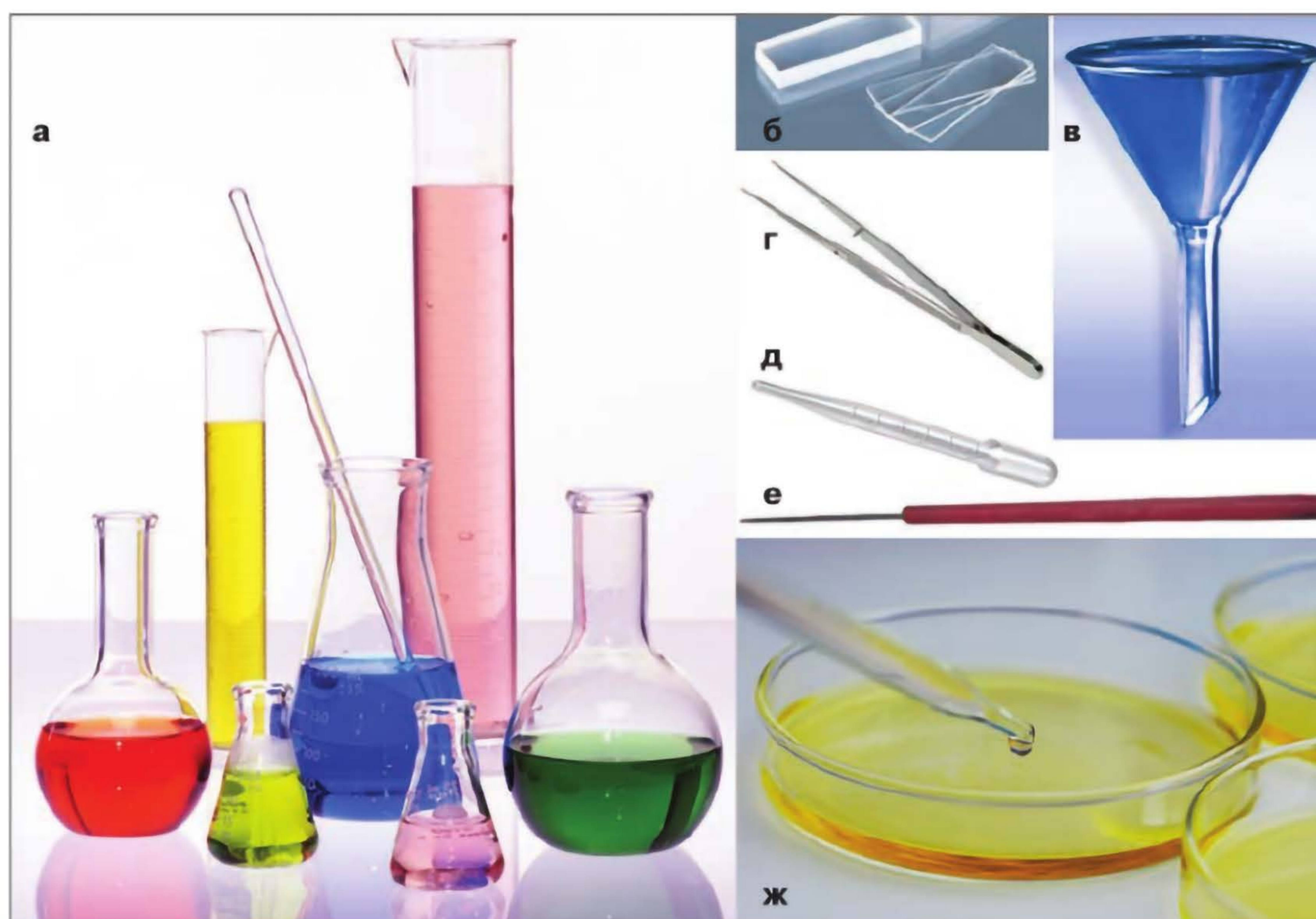
Рис. 12. Лабораторная посуда и оборудование: колбы и мерные цилиндры (а); предметные стёкла (б); воронка (в); пинцет (г); пипетка (д); препаровальная игла (е); чашка Петри (ж)
