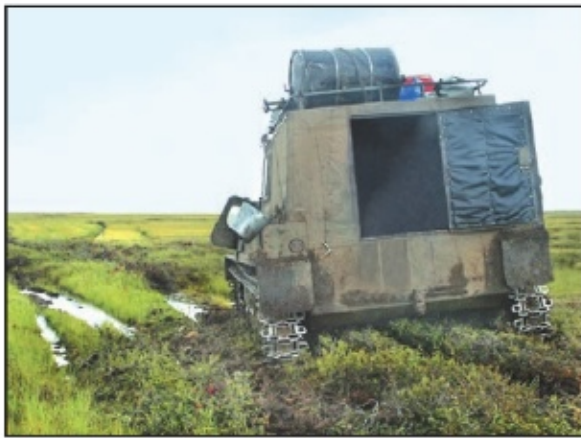
Вездеход на гусеничном ходу разрушает поверхность почвы в тундре
