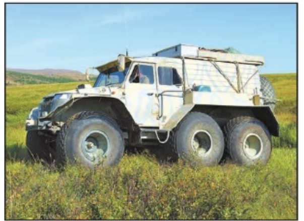
Вездеход на шинах сверхнизкого давления почти не оставляет следов
