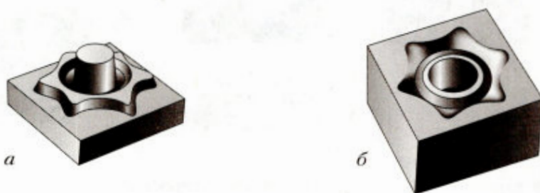
Рис. 45. Электрод-инструмент (а) и полученная методом электроэрозионного копирования деталь (б)
