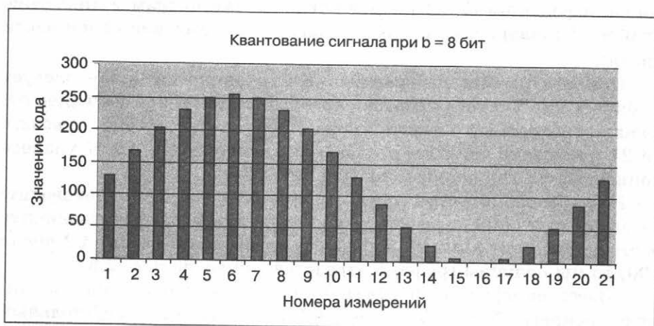
Рис. 2.5. Аналого-цифровое преобразование с частотой дискретизации 400 Гц
